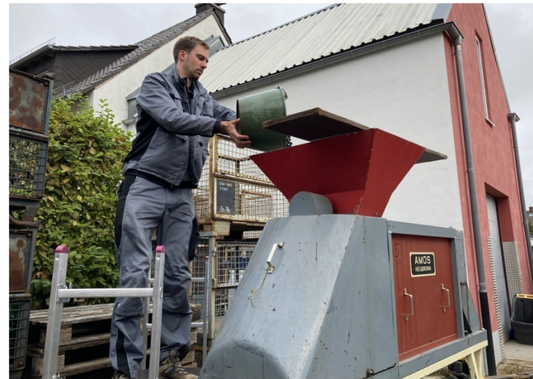
Die "Entrapp"-Maschine trennt die Stiele von den Beeren
