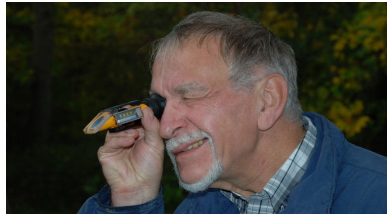
Ermittlung des Oechsle-Grades mit dem Refraktometer
